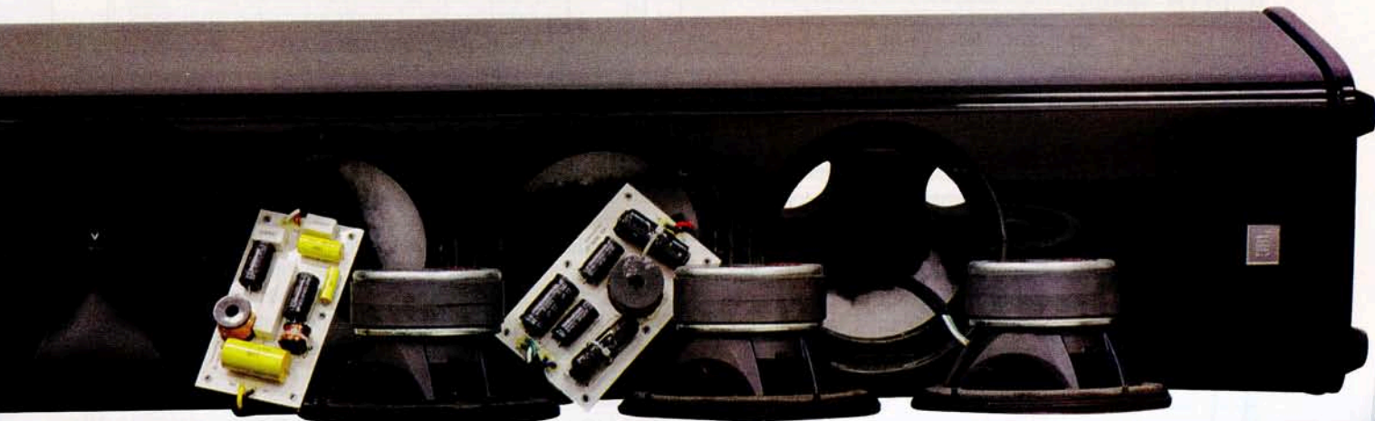
Il diffusore smontato. Notare i due circuiti stampati per il filtro crossover ed i tre woofer identici tra loro, con cestello in pressofusione e doppi anelli di ferrite.
